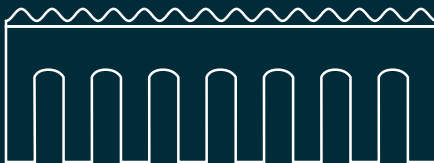
Gerade mit Ausklinkung (GmA) Straight and notched (SN)
